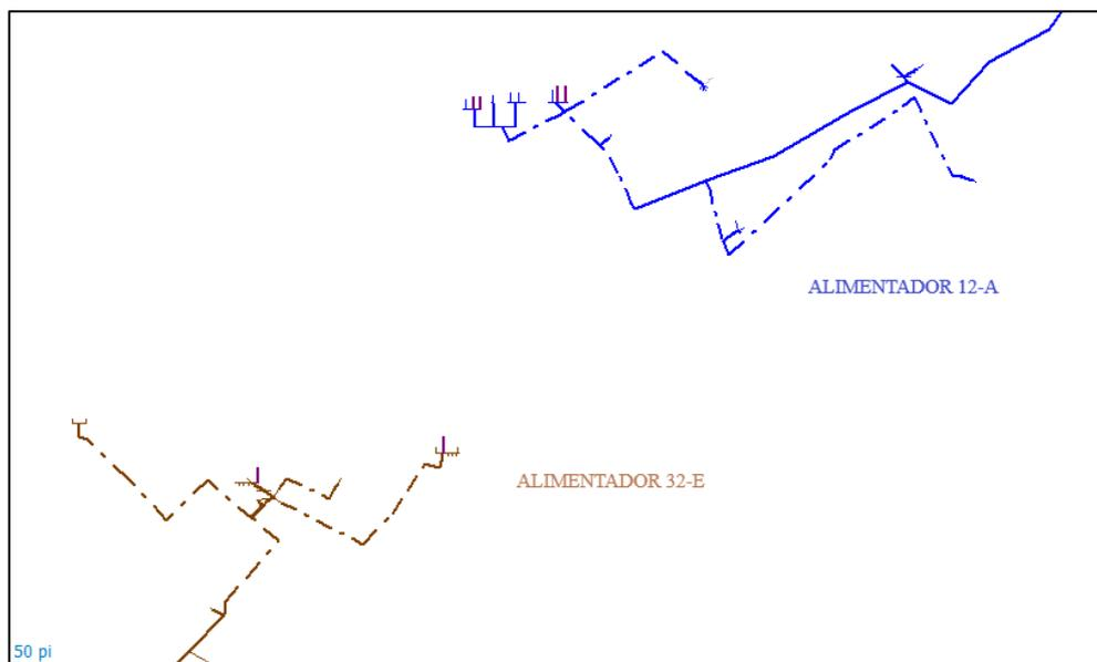
**Figura 16.** Esquema de la Red Eléctrica involucrada en el Sistema de Transferencia de Carga (Elaborado en CYME).[11]
