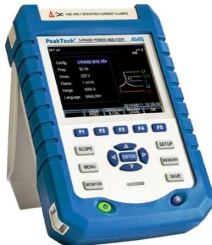
**Figura 11.** Analizador de Potencia Trifásico TFT -(PeakTech).[10]
