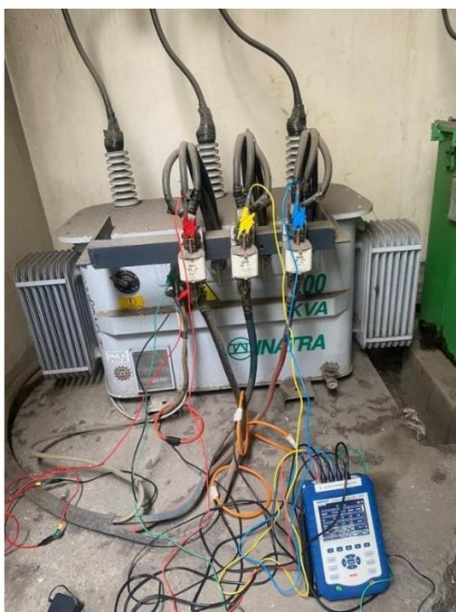
**Figura 12.** Recolección de mediciones en el transformador (ICB y Aulas Mecánica)
