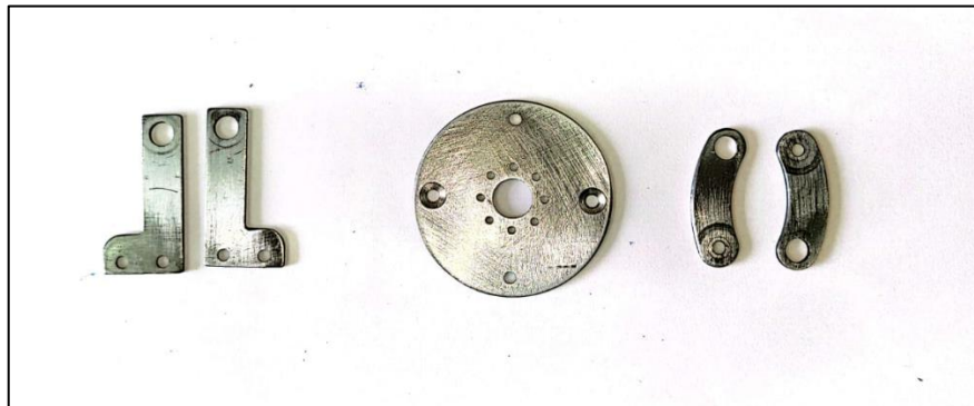
Figura 2.1. Palanca, adaptador y levas del efector final tipo pinza de 2 dedos.
