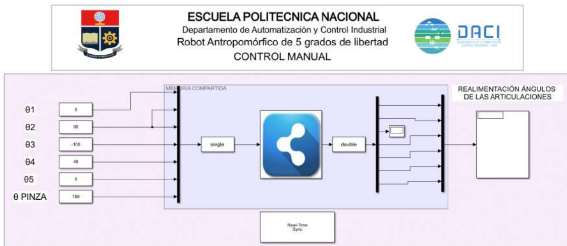
Figura 6.1. Interfaz control manual de los motores
