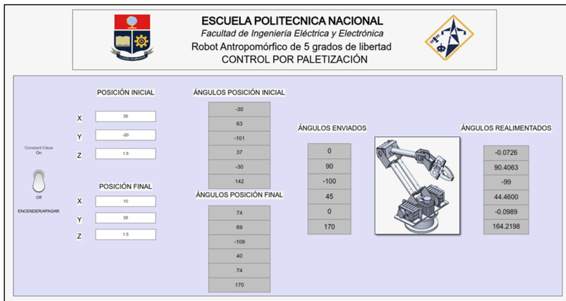
Figura 3.7. HMI con posición inicial deseada X=35 , Y=-20 y Z=1.5 y la posición final X=10 , Y=35 y Z=1.5 .
