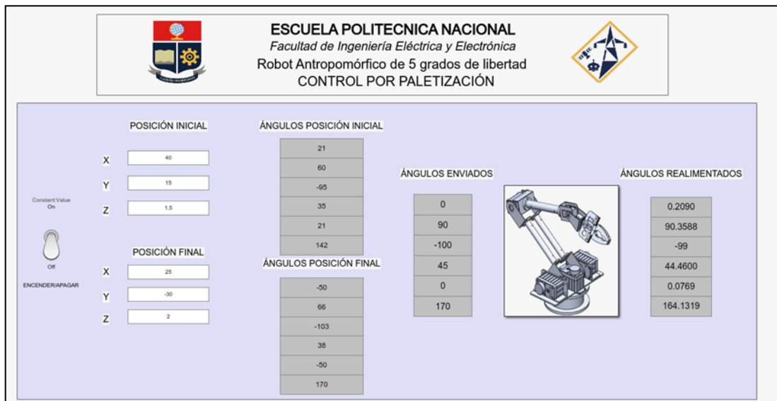
Figura 3.1. HMI con posición inicial deseada X=40 , Y=15 y Z=1.5 y la posición final X=25 , Y=-30 y Z=2
