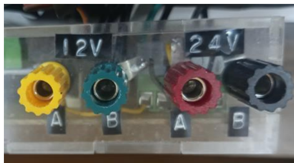
Figura I.2. Borneras de alimentación
