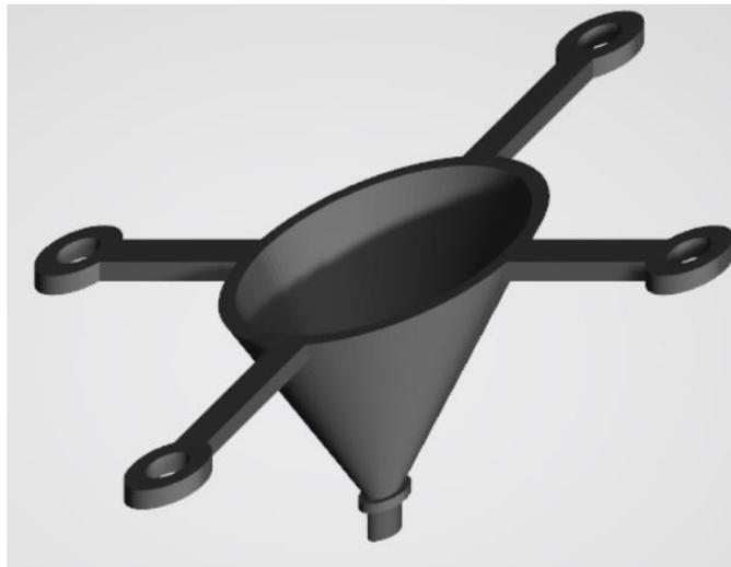
**Figura 14. Diseño de cono para colimación en el techo. [Autoría Propia]**
