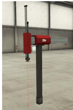
Figura 1.2. Posicionador de dos ejes en Factory I/O
