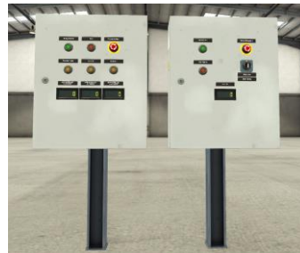
Figura 1.7. Tableros con elementos de control en Factory I/O
