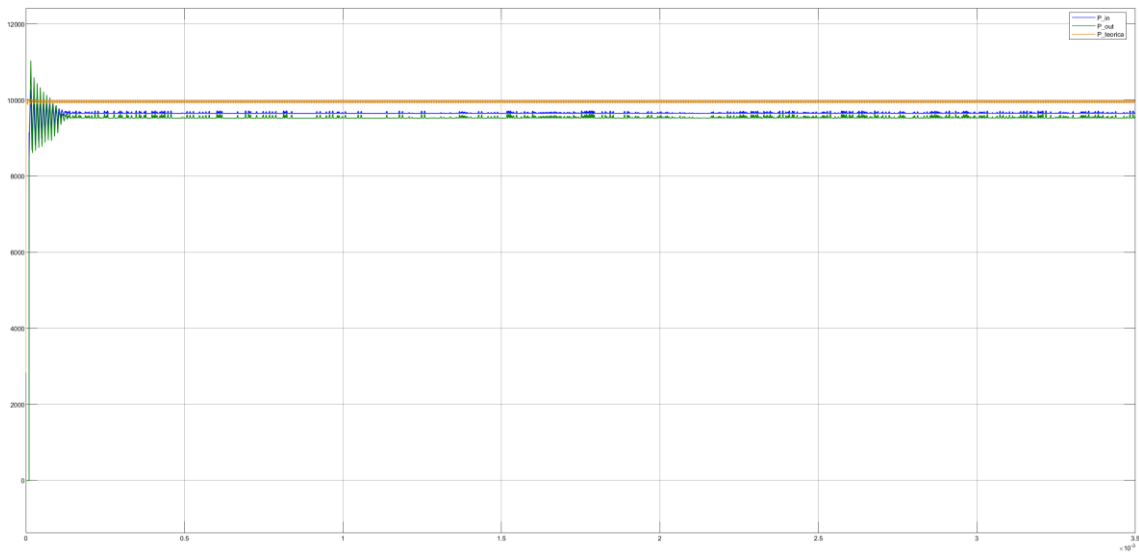
Figura IV.16. Curvas de potencias de salida(rojo), entrada (azul) y teórica (naranja) en de los puentes a una salida de 600V y d = 0.21
