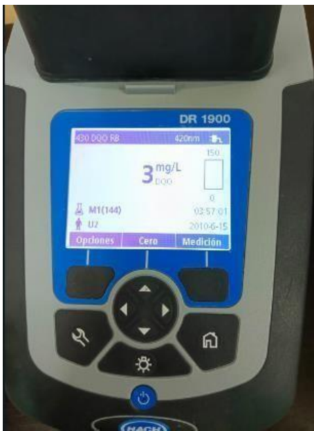
Figura 9: Resultado Obtenido por Espectrofotometría de DQO.
