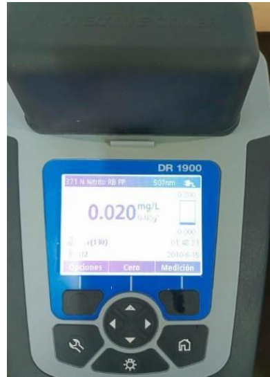
Figura 12: Resultado obtenido por Espectrofotometría de Nitritos.
