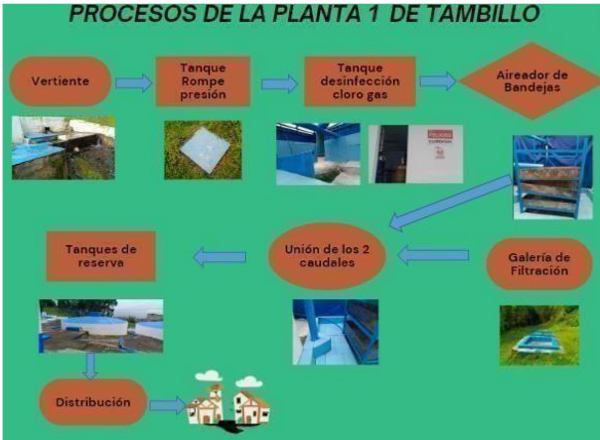
Figura 4: Diagrama de Flujo para procesos de la Planta 1 de Tambillo
