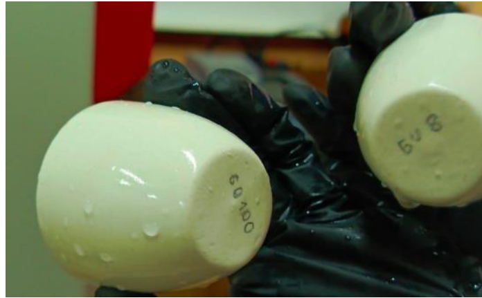
Figura 8: Crisoles Identificados para la determinación de sólidos totales, suspendidos y disueltos.
