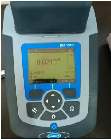
Figura 13: Resultado obtenido por Espectrofotometría de Manganeso.
