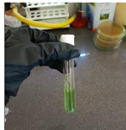
Figura 16: Resultado Positivo Coliformes Totales
