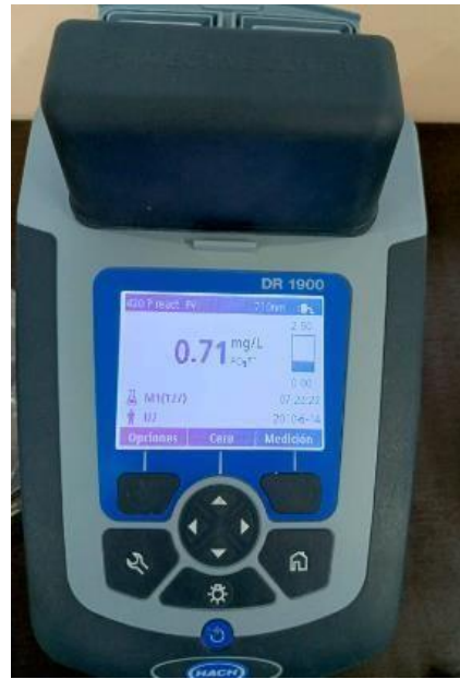
Figura 10: Resultado obtenido por Espectrofotometría de fosfatos.
