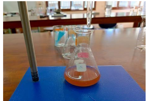
Figura 4: Coloración obtenida de la titulación de Cloruros
