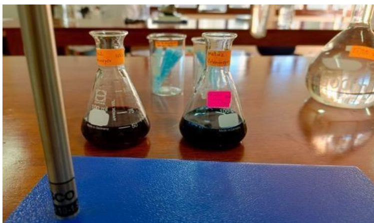
Figura 5: Coloraciones obtenidas de la titulación de Dureza Total y Cálcica.
