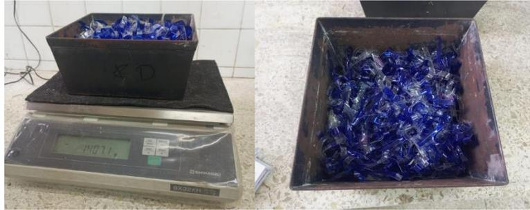
**Figura 12.** Peso en seco del PET, ensayo de absorción.
