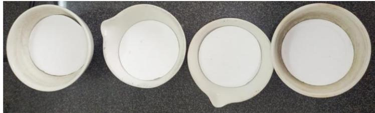
**Figura 33.** Filtros del ensayo de sólidos suspendidos.
