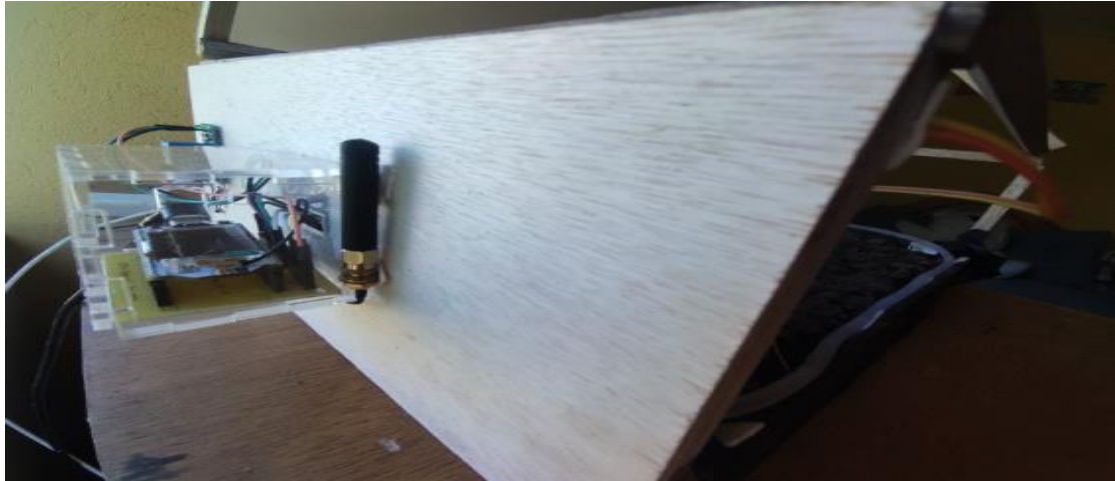
Figura 3.83 Energización del SoC esclavo, sensores y relé
