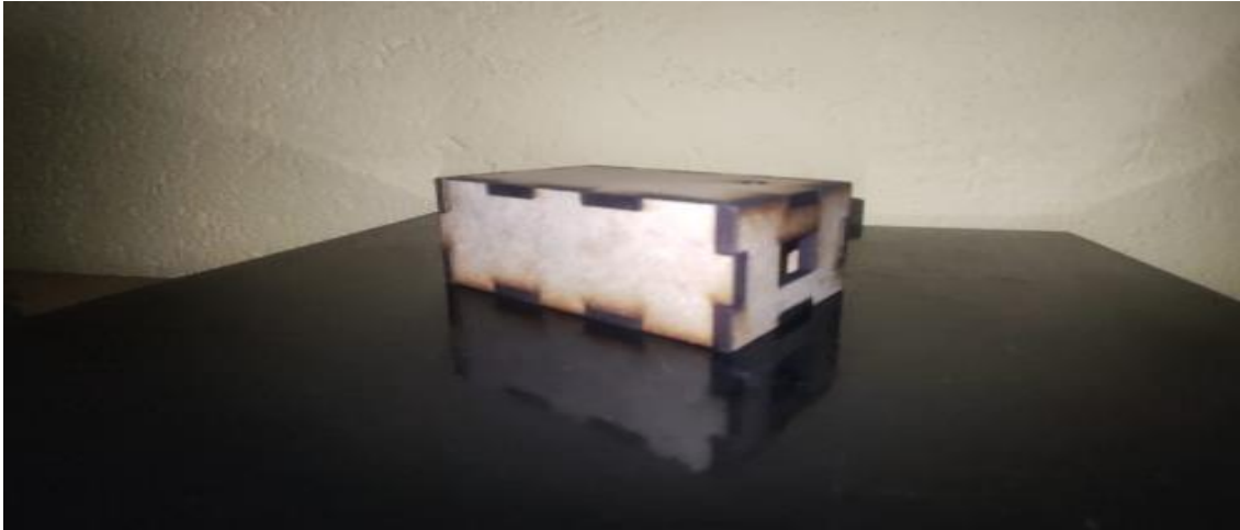
Figura 3.77 Protección para el SoC maestro
