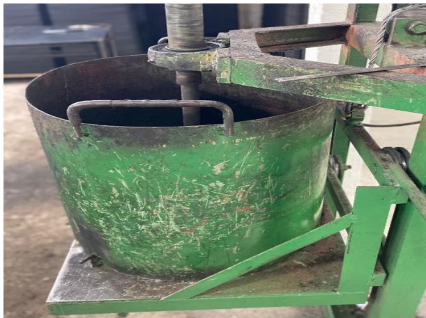
Figura 19. Proceso de mezclado en la mezcladora 2 para la producción de discos bumpers.
