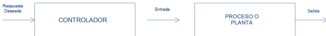
**Figura. 9.** Representación general del control automático de tipo "lazo abierto", sintetizado. [1]
