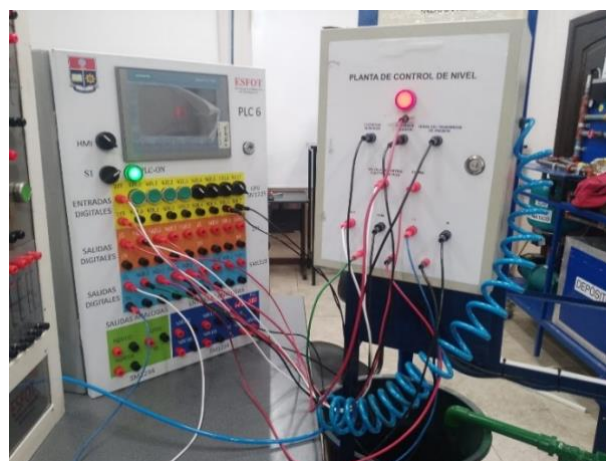
Figura 3.5. Conexión de la planta con el PLC
