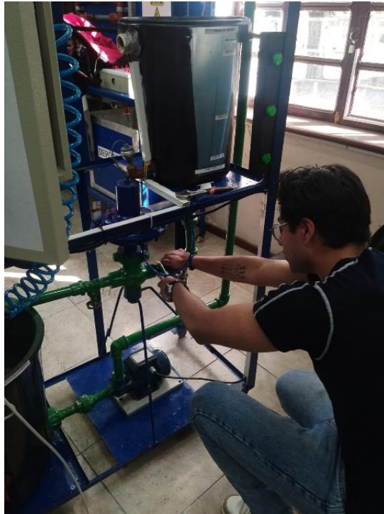
Figura 3.4. Detección de fugas
