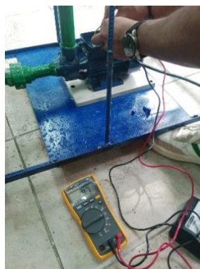
Figura 2.8. Medición en ohmios del devanado principal
