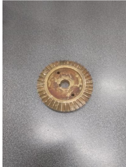
Figura 2.16. Álabes en mal estado
