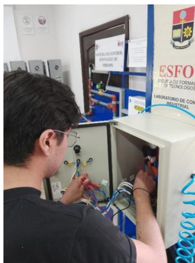
Figura 2.6. Comprobación de continuidad
