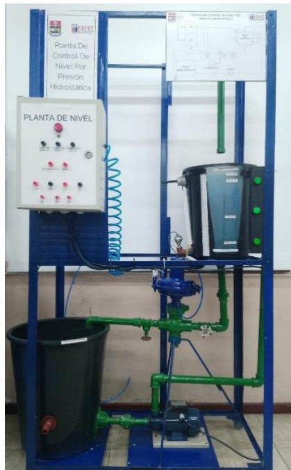
Figura 3.1. Planta Repotenciada de Nivel
