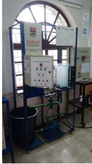
Figura 2.1. Planta de control de nivel por presión hidrostática LTI – ESFOT
