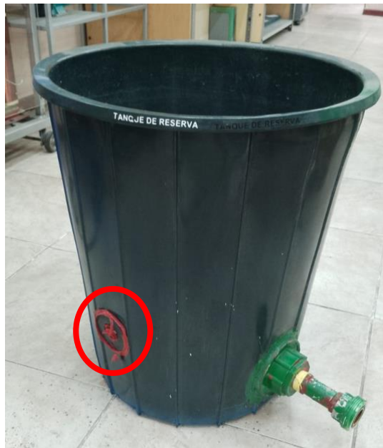
Figura 2.17. Tanque de almacenamiento sin el sensor tipo boya
