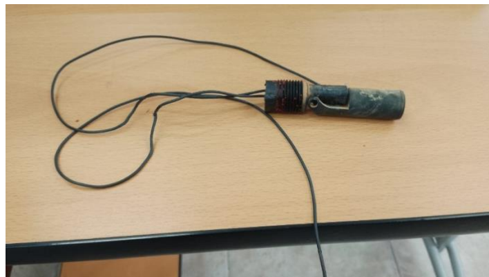
Figura 2.18. Sensor tipo boya desmontado
