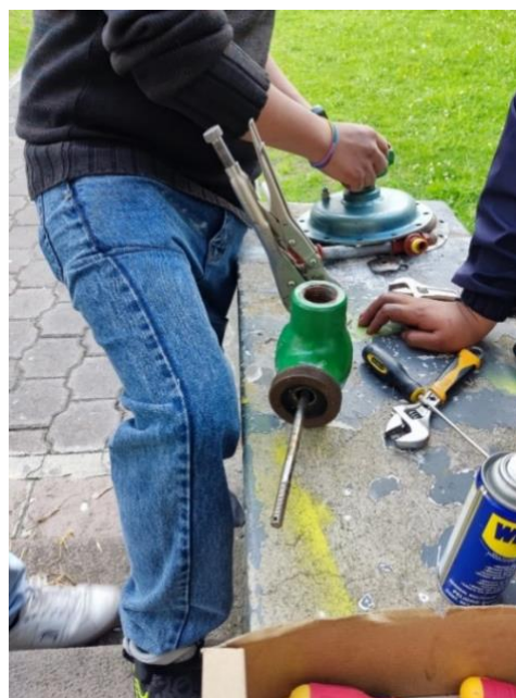
Figura 2.13. Desmontar válvula de control de nivel
