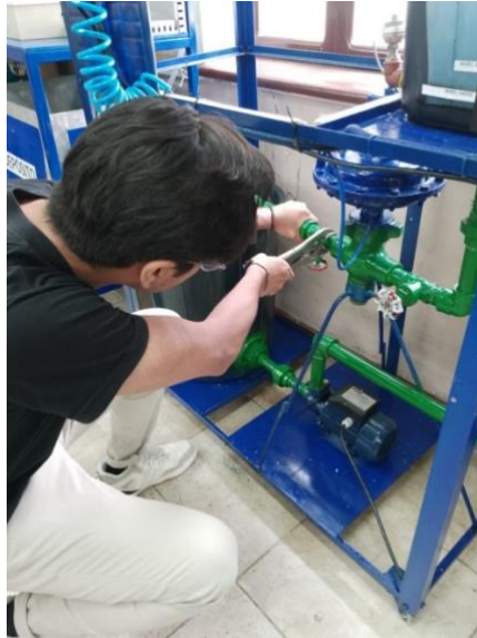
Figura 2.3. Desmonte de tuberías
