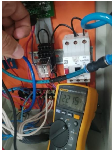
Figura 2.20. Conversión de corriente [mA] a [V]
