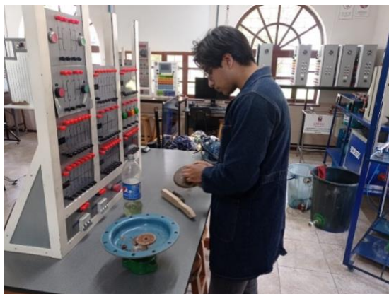
Figura 2.11. Mantenimiento de la válvula de control de nivel
