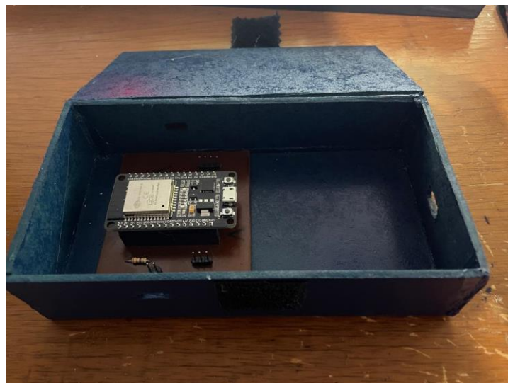
Figura 3.40 Fijación de la PCB en la caja de protección
