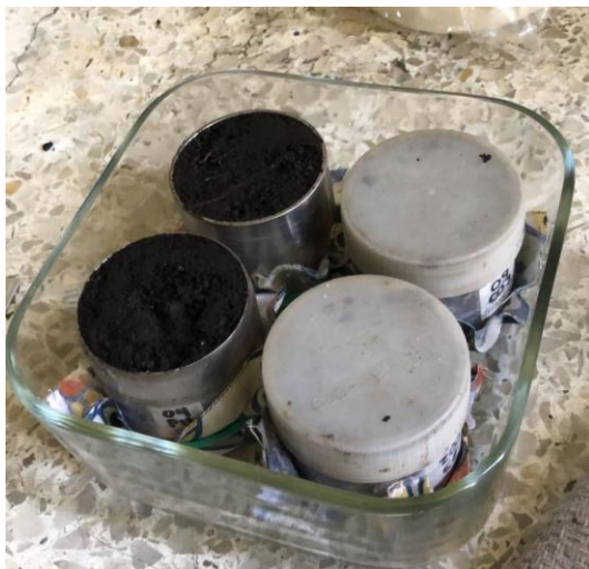
Figura 18. Muestras inalteradas en saturación para contenido volumétrico de agua
