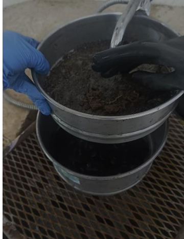
Figura 12. Tamizado de la muestra para granulometría
