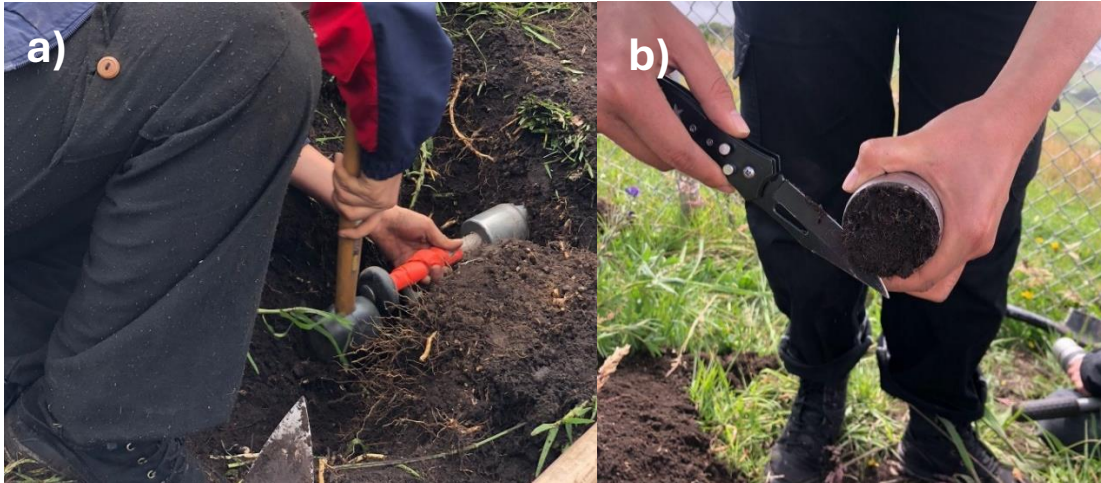
Figura 6. Muestro con los anillos Kopecky en la estación C02
