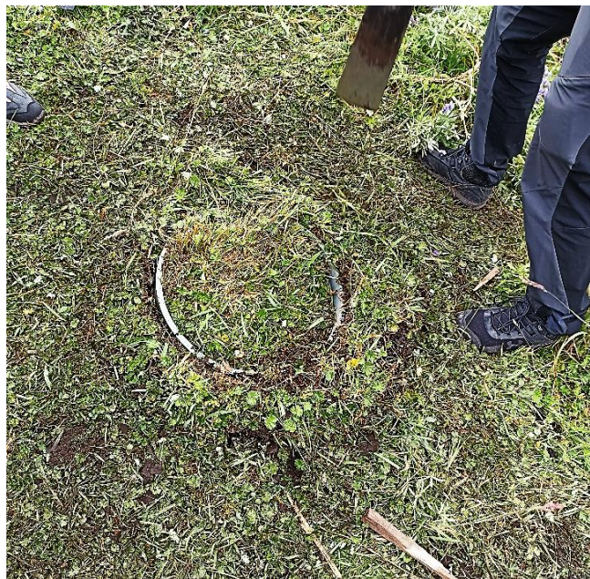
Figura 4. Cilindro de PVC enterrado para la toma de muestra inalterada
