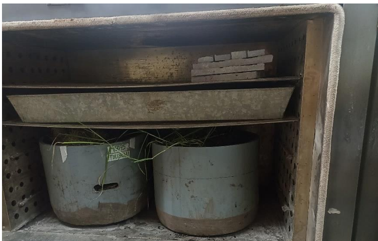
Figura 19. Muestra inalterada de la estación C02 dentro del horno.
