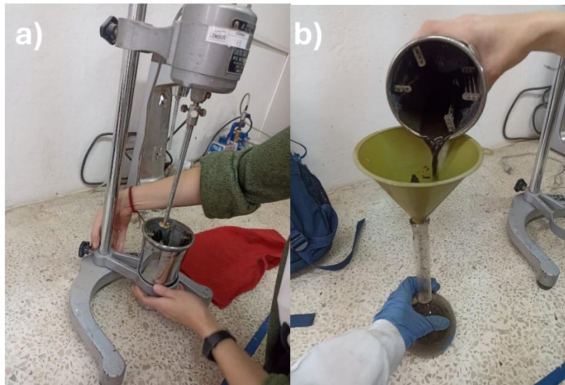
Figura 9. Preparación de la muestra para utilizar en la bomba al vacío
