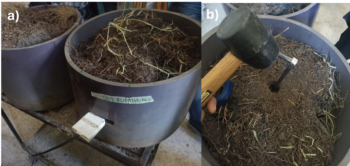
Figura 20. Muestra después de estar en el horno y toma de última muestra
