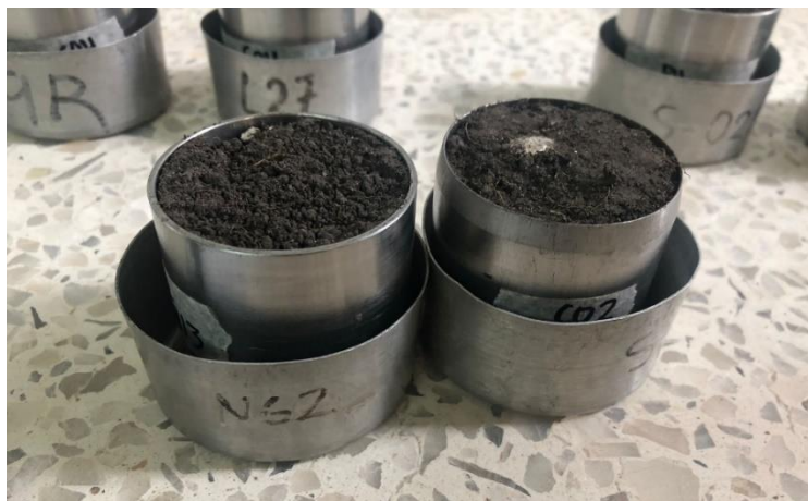
Figura 11. Muestras inalteradas para densidad aparente
