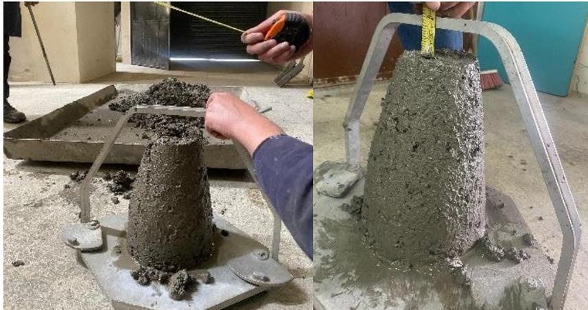
**Figura 2.22** Retiro del cono y medición del asentamiento.
