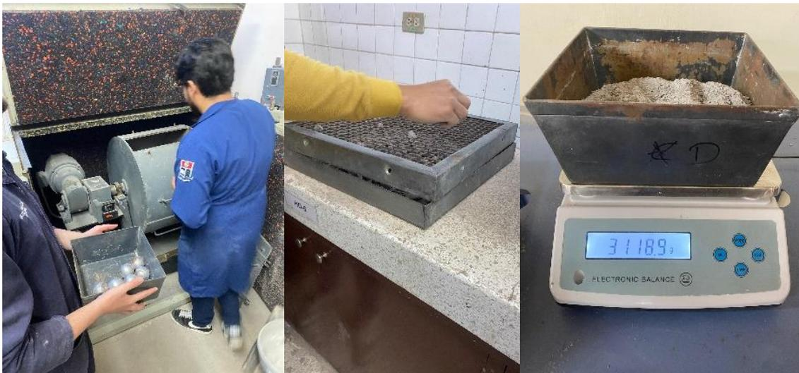
**Figura 2.19** Uso de la máquina de Los Ángeles y procedimiento del ensayo.
