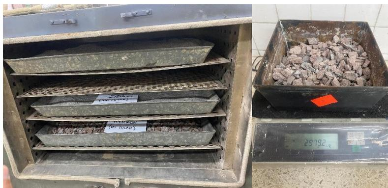
**Figura 2.14** Peso y secado del agregado.
