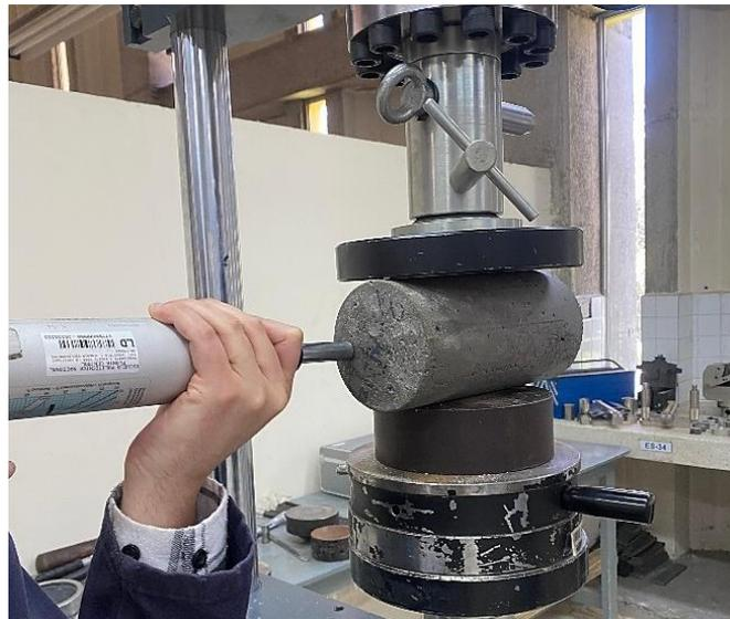
**Figura 2.1** Proceso de ensayo con esclerómetro.
