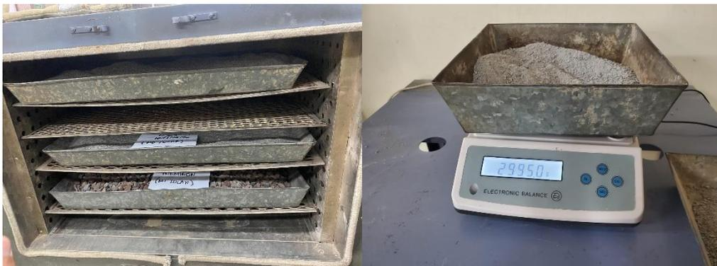
**Figura 2.12** Preparación y secado del agregado.
