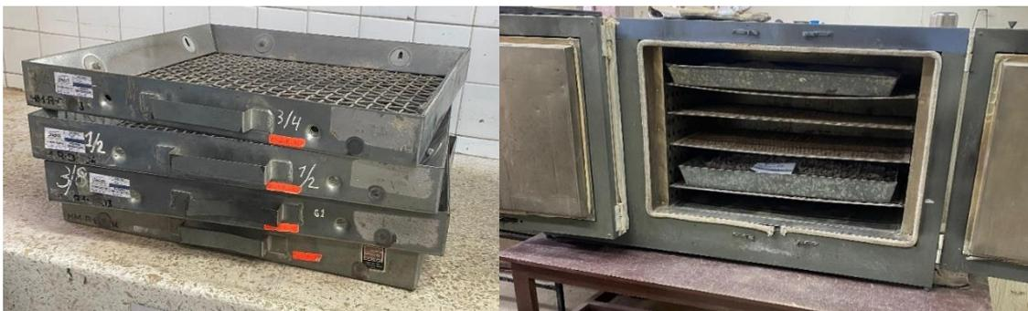
**Figura 2.7** Preparación de tamices y secado del agregado.
