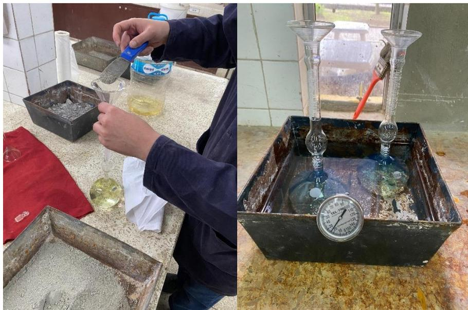
**Figura 2.10** Adición de cemento y control de temperatura.
