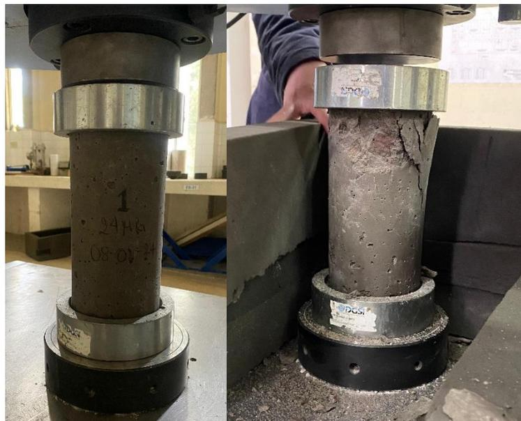
**Figura 2.5** Colocación del cilindro e identificación de tipo de falla.
