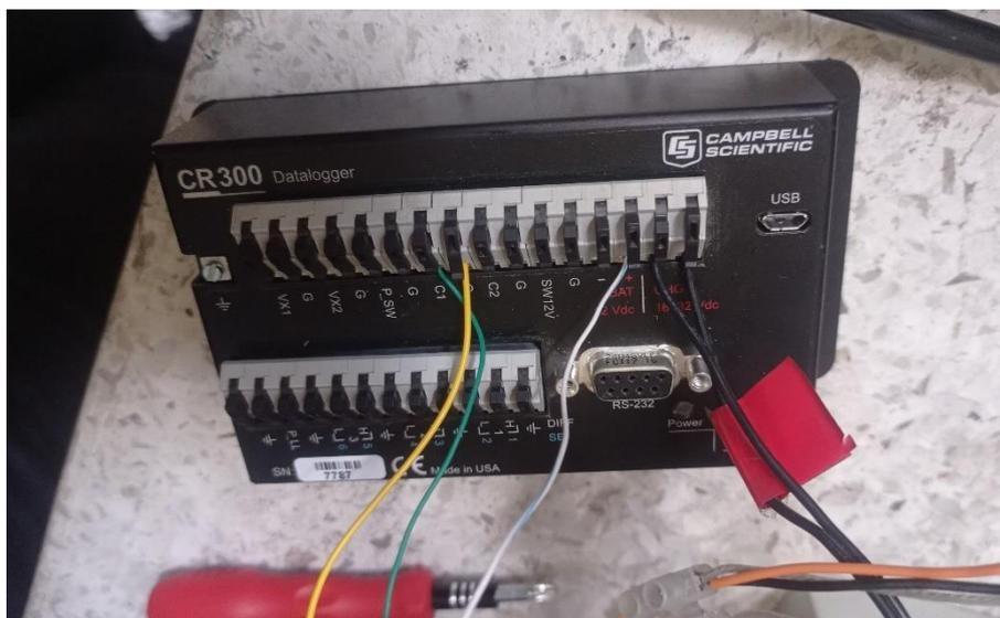
**Figura 13:** Conexiones de reflectómetros al Datalogger CR300
