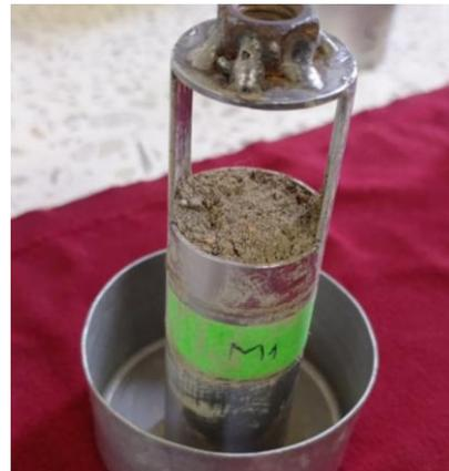
**Figura 19:** Submuestra después de 24 h a  $110^{\circ}\text{C}$
