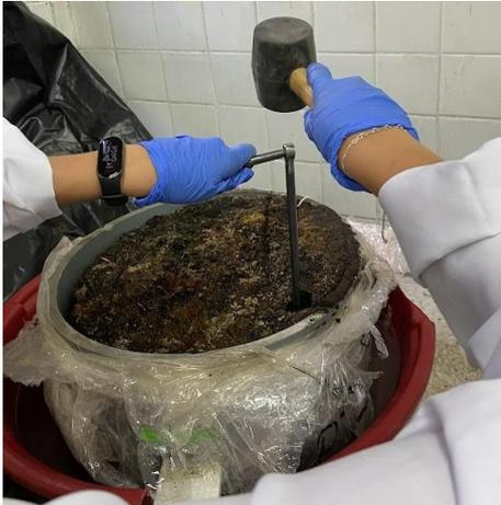
**Figura 16:** Toma de submuestras inalteradas
