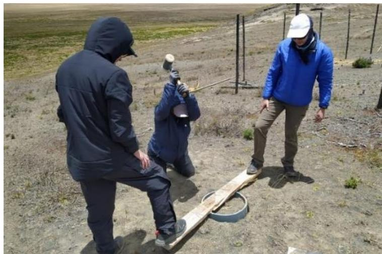
**Figura 6:** Inserción del muestreador de PVC en el suelo
