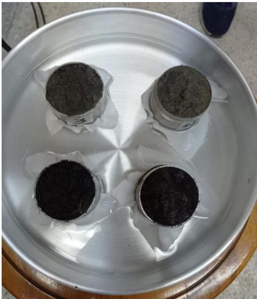
**Figura 20:** Saturación de muestras pequeñas inalteradas
