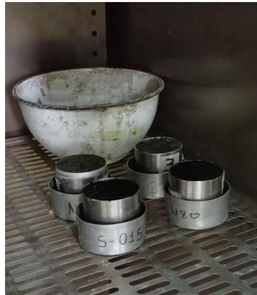
**Figura 21:** Secado de muestras saturadas a 110°C por 24 h
