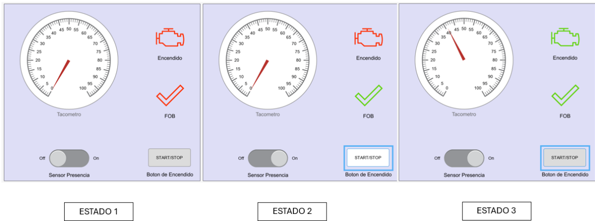
Figura 3.4. Secuencia de encendido.
