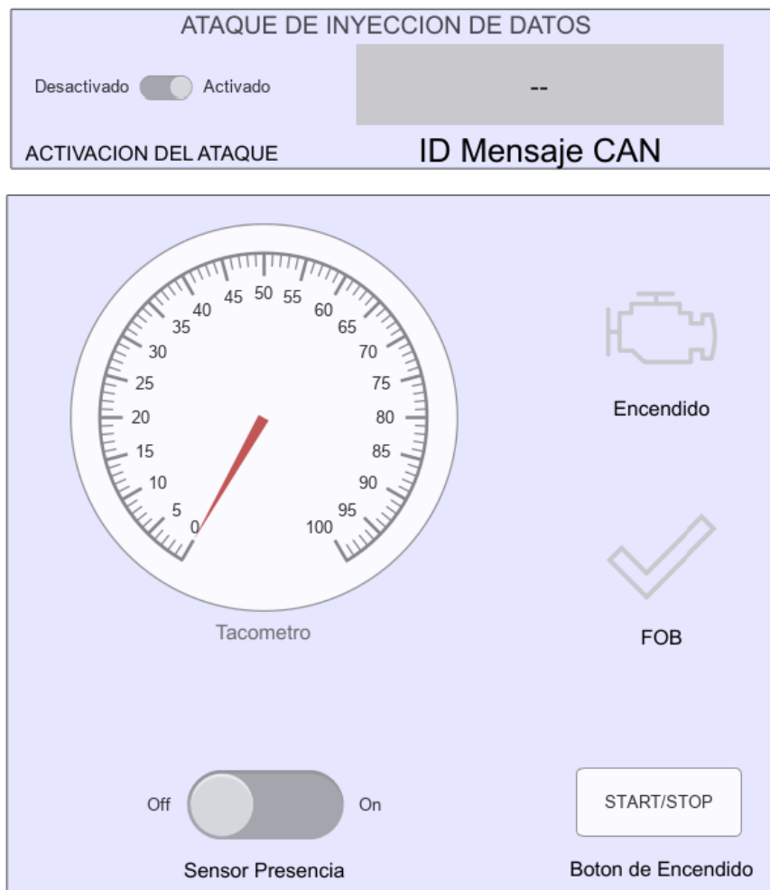
Figura 2.33 Tablero, Sistema de Encendido con Ataque.
