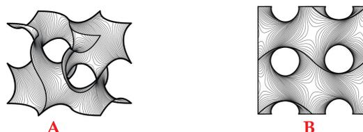
**Figura 3.3:** A. Representación de una sección del giroide B. Corte transversal de dicha sección
