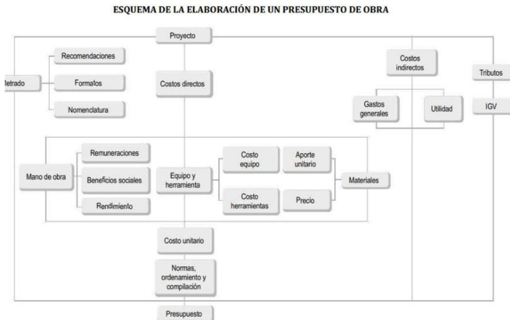
**Figura 1.5.** Esquema de la elaboración de un presupuesto de obra
