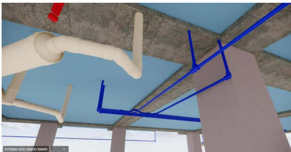
**Figura 2.19.** Recorrido de interferencias estructural vs hidrosanitario
