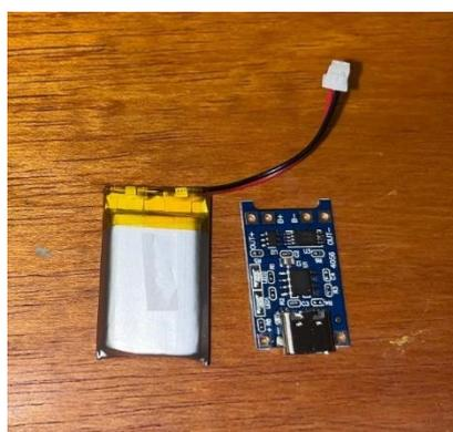
*Figura 2.30: Módulo de carga y batería recargable.*
