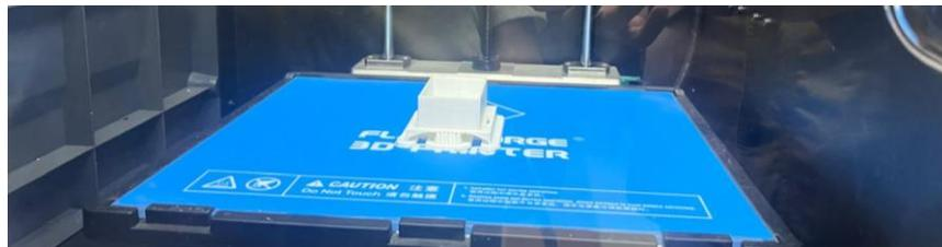
Figura 2.41: Impresión del contenedor de las placas.
