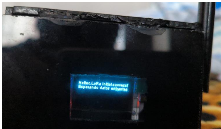
Figura 3.42 Visualización en la pantalla OLED receptor
