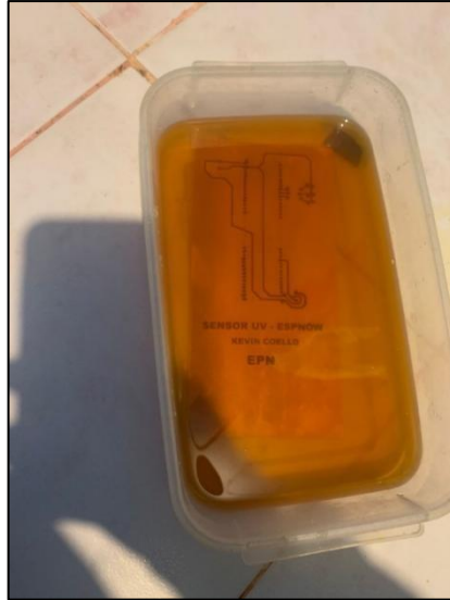
Figura 3.30 Etapa de grabado de diagrama en PCB
