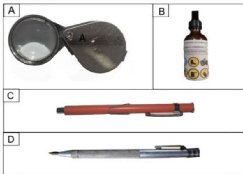
Figura 3.1: Materiales utilizados para la descripción macroscópica de las muestras. A) Lupa de mano de 20X. B) Ácido clorhídrico al 10% de concentración. C) Lápiz magnético. D) Rayador de carburo de tungsteno.
