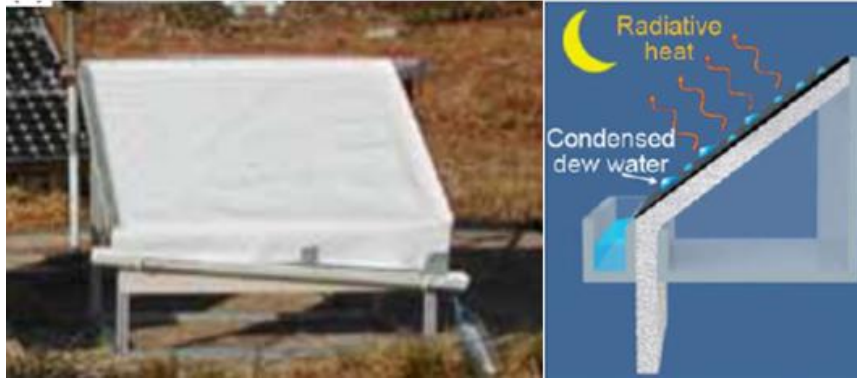
Figura 3. Método Pasivo: Enfriamiento Radiativo [6].
