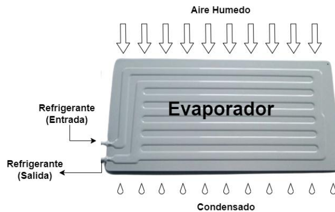
Figura 31. Esquema del Evaporador de Superficie de Placa Plana [Fuente Propia].
