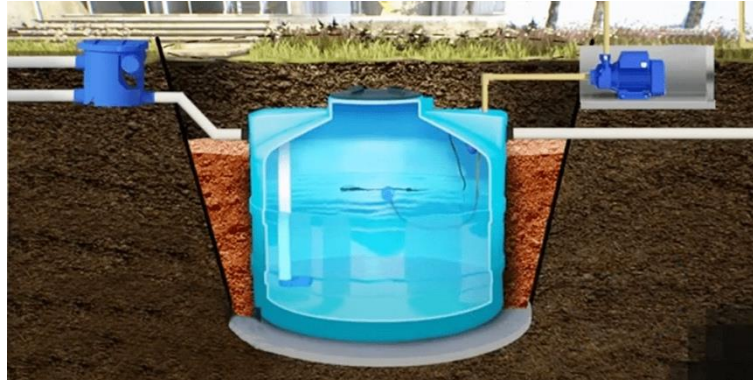
Figura 16. Sistema de almacenamiento subterráneo, cisterna.[19]
