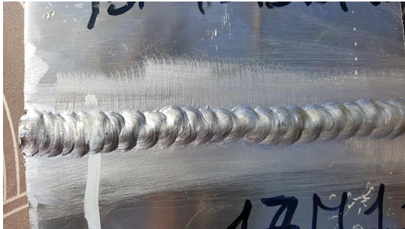
Figura 20. Cordón de soldadura.[27]
