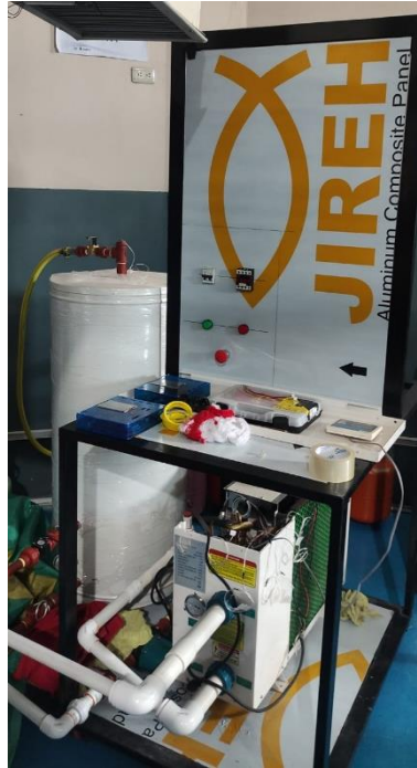
Figura 38. Montaje de la estructura y equipo de calentamiento de agua. [Fuente propia]
