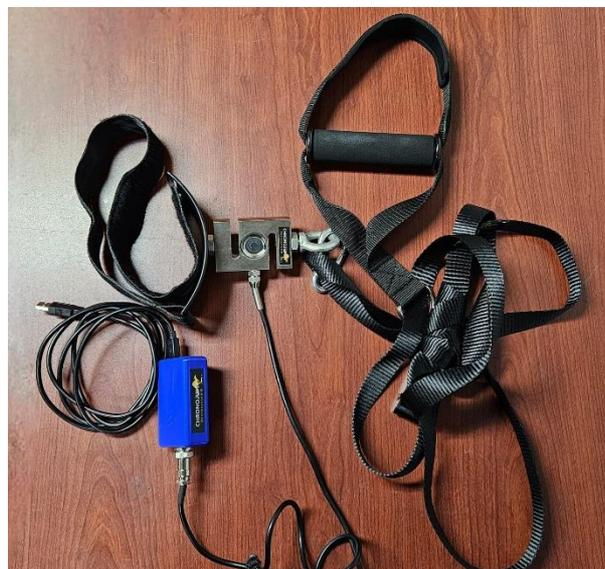
**Figura 2.11.** Chronojump Force Sensor y accesorios.
