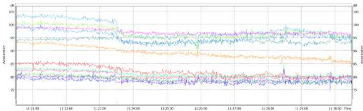
Resultado de medición en trampa de vapor de flotador y termostato
