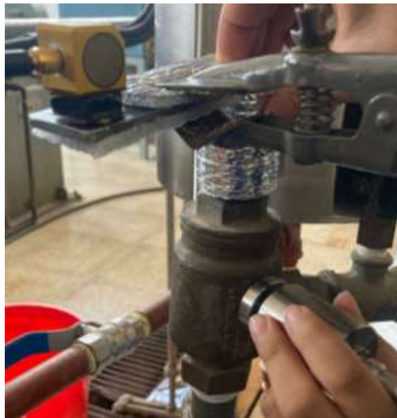
Figura 2.10. Proceso de medición en la trampa termostática bimetalica del destilador
