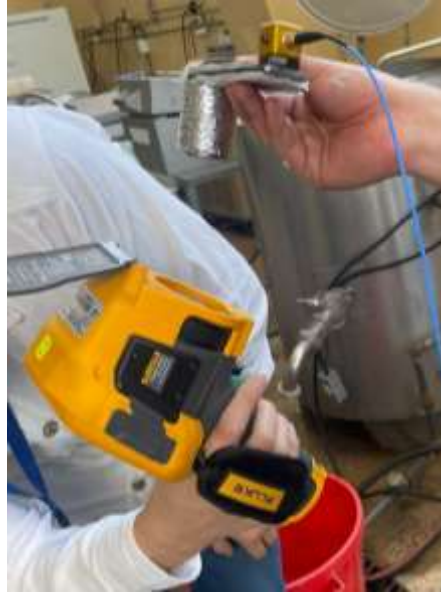
Figura 2.6. Verificación de la temperatura superficial con cámara termográfica
