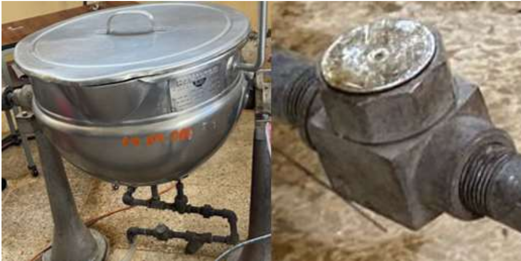
Figura 2.7. Marmita Hamilton y Trampa de vapor SpiraxSarco
