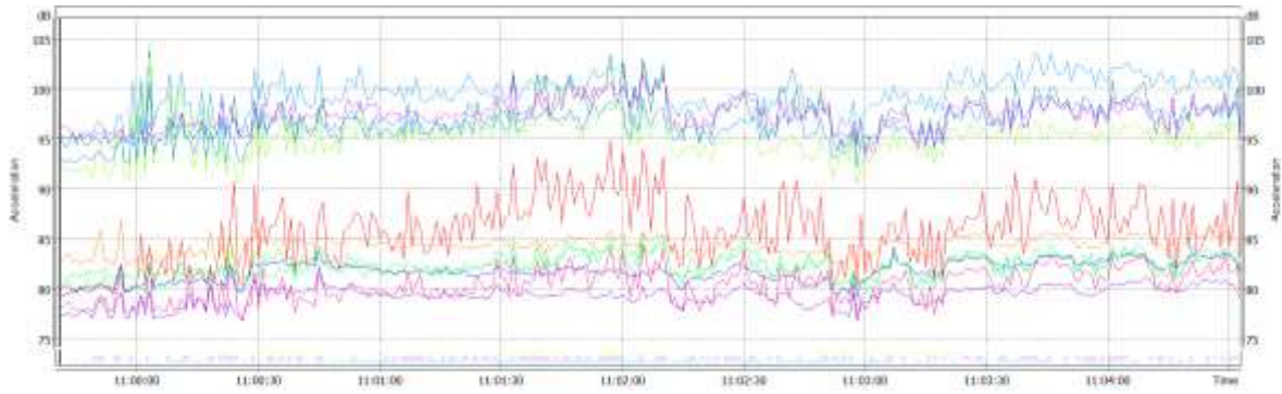
Resultado de medición en trampa de vapor de balde invertido
