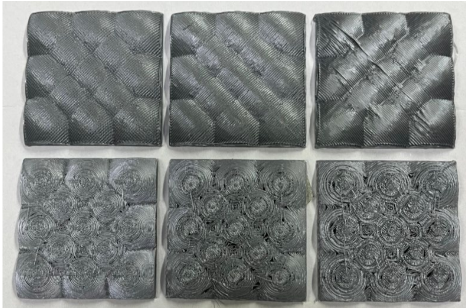
Figura 27 Modelo "T3" impreso en no planar (parte superior) y planar (parte inferior) con alturas de capa de 0.18 mm (izquierda), 0.28 mm (centro) y 0.38 mm (derecha)
