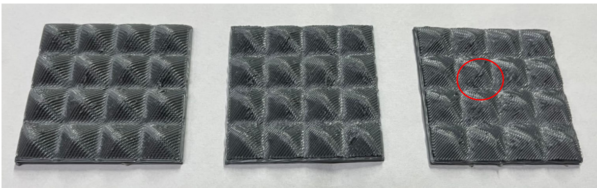
Figura 21 Modelo "T2" con alturas de capa de 0.18 (izquierda), 0.28 (centro) y 0.38 (derecha)
