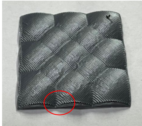
Figura 24 Muestra de error en la mayor inclinación que presenta el modelo "T3"
