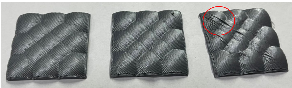
Figura 22 Modelo "T3" con alturas de capa de 0.18 (izquierda), 0.28 (centro) y 0.38 (derecha)
