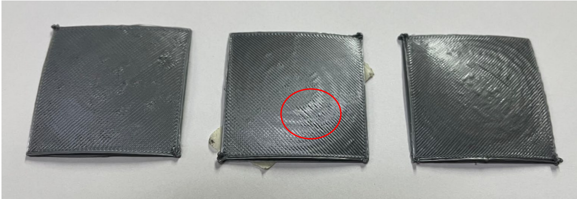
Figura 20 Modelo "T1" con alturas de capa de 0.18 (izquierda), 0.28 (centro) y 0.38 (derecha)
