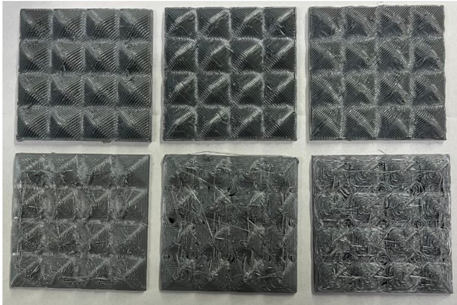
Figura 26 Modelo "T2" impreso en no planar (parte superior) y planar (parte inferior) con alturas de capa de 0.18 mm (izquierda), 0.28 mm (centro) y 0.38 mm (derecha)
