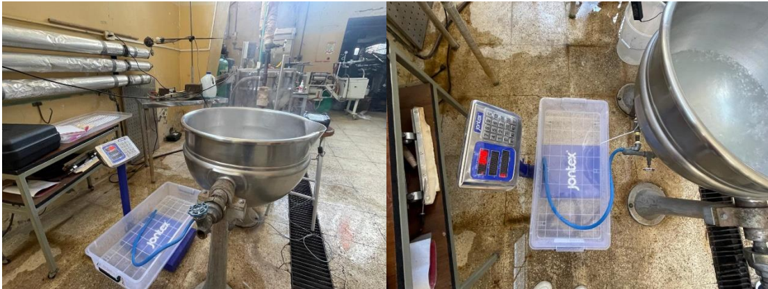
Figura 5.5. Sistema implementado para medición de condensado.
