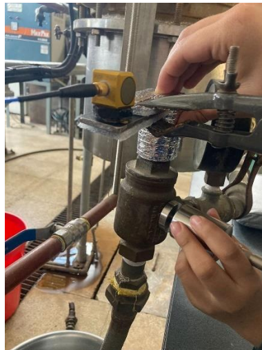
Figura 5.4. Montaje del sensor en la trampa termostática
