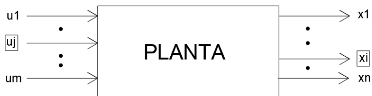
Figura 3. Esquema gráfico – Modelación en función de transferencia Fuente: Aguinaga, A., & Cruz, D. (2008). Control automático
