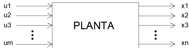
Figura 2. Esquema gráfico – Modelación en espacio de estado Fuente: Aguinaga, A., & Cruz, D. (2008). Control automático
