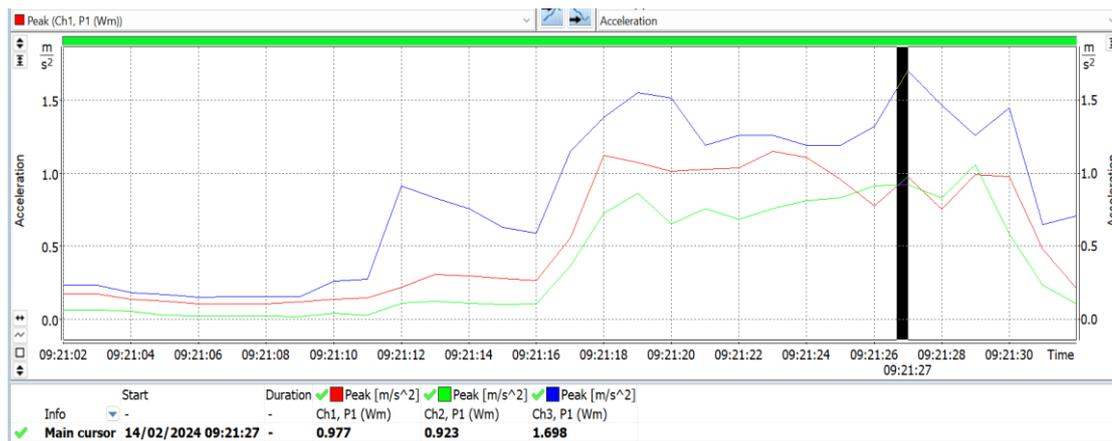
**Figura 2.19** Variación de la aceleración en el eje x, y y z vs tiempo, que experimenta la base de la cambian.
