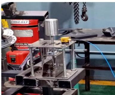
**Figura 2.20** Montaje del acelerómetro en palanca de cambios
