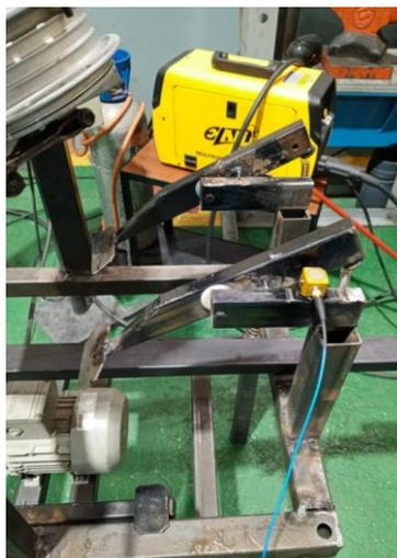
**Figura 2.22** Montaje del acelerómetro en el pedal
