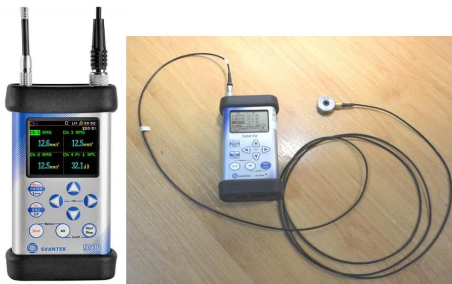
**Figura 2.17** Analizador de vibraciones SVAN 958A.
