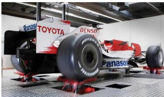
**Figura 1.1** Plataforma vibratoria en el uso de vehículos de carreras
