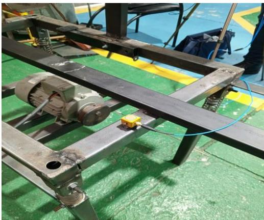
**Figura 2.18** Montaje del acelerómetro en la base del prototipo de cabina de conducción.
