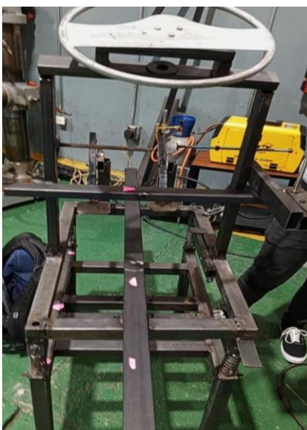
**Figura 1.13** Prototipo del sistema de simulación de vibraciones para transporte pesado
