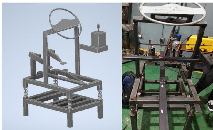
*Figura 2.4* Prototipo del sistema de simulación de vibraciones y cad
