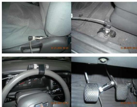
**Figura 1.4** Disposición de los acelerómetros dentro de la cabina
