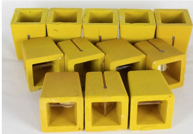
Figura 3 Copas de arena con y sin telurio
