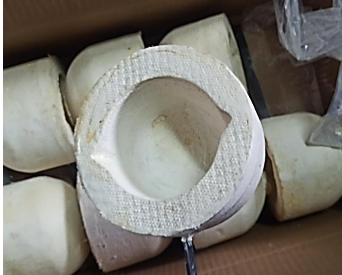
Figura 20 Cuchara para recolección de muestras de hierro fundido
