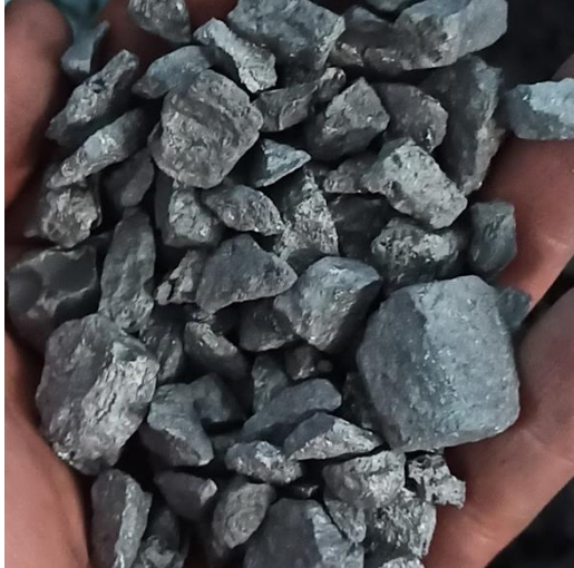
Figura 26 Liga para Nodulización FeSiMg
