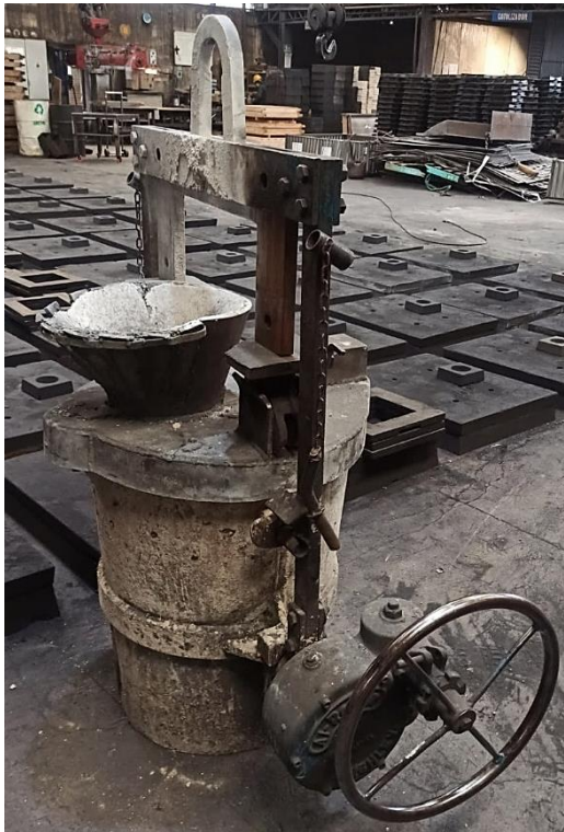
Figura 27 Cuchara cónica para tratamiento de nodulización
