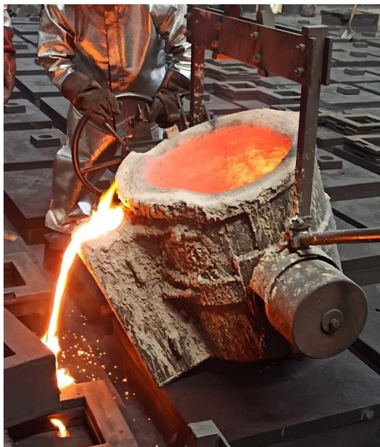
Figura 29 Cuchara de transporte y vertido de material en molde
