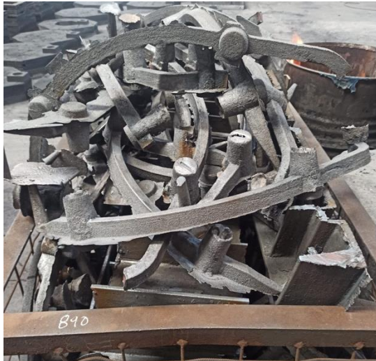
Figura 22 Retorno del proceso de fundición
