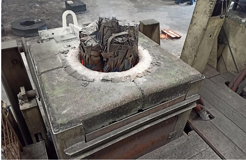
Figura 21 Horno cargado con tochos de retazos de acero
