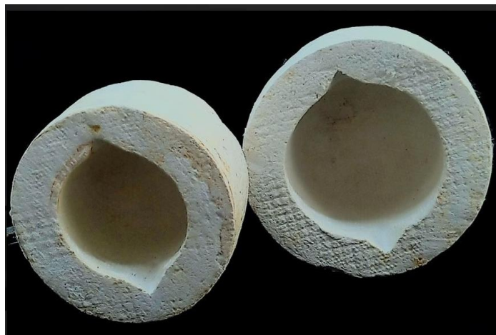
Figura 4 Cuchara refractaria para toma de muestras
