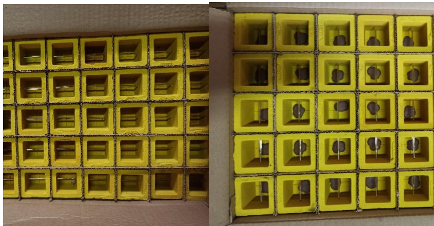
Figura 19 Copas para análisis térmico
