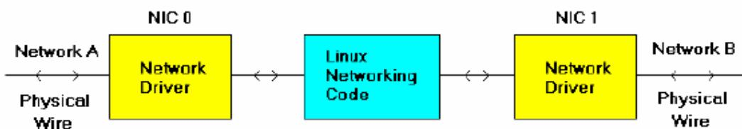
**GRÁFICO 3.2** Diagrama de Bloques de un Computador con dos tarjetas de Red.
