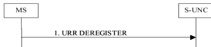
Figura 2.8: De-Registración iniciada por la estación móvil
