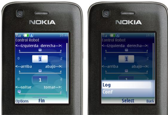
Fig. 12. Pantallas para el control y configuración del brazo robot: Control robot y menú Control robot
