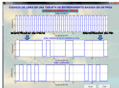
Figura 9: Gráfica de la Señal de Reloj, Señal a Codificar y Señal Codificada.
