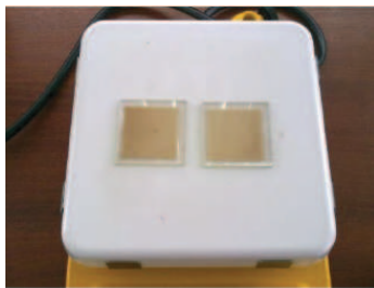
Figura 7. Sinterizado del electrodo de \text{TiO}_2 a 450 °C por 10 min.
