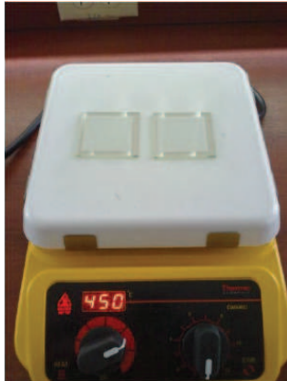
Figura 7. Sinterizado del electrodo de \text{TiO}_2 a 450 °C por 10 min.
