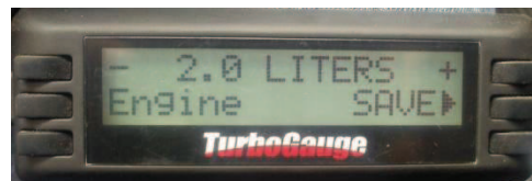
Figura 8 Cuadro para ajuste del tamaño de la cámara de combustión del motor.
