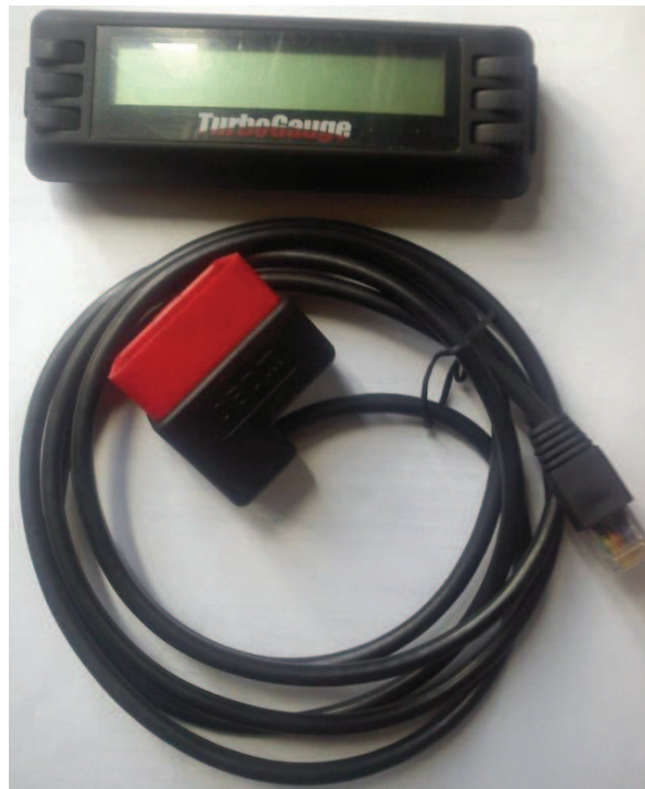
Figura 2.8 Receptor electrónico de datos (Turbo Gauge)
