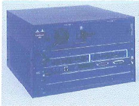
**Figura N° 32: Conmutador ATM <sup>48</sup>**
