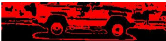
Figura 15 Imagen binaria producida por el bloque IMAQ Threshold
