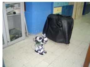
Figura 4.6a Robot detectando una superficie de cuero.
