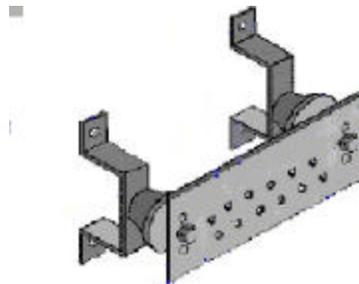
La TMGB debe ser una barra de cobre, con perforaciones roscadas según el estándar NEMA. Debe tener como mínimo 6 mm de espesor, 100 mm de ancho y largo adecuado para la cantidad de perforaciones roscadas necesarias para alojar a todos los cables que lleguen desde las otras barras de tierra de telecomunicaciones. Deben considerarse perforaciones para los cables necesarios en el momento del diseño y para futuros crecimientos.
