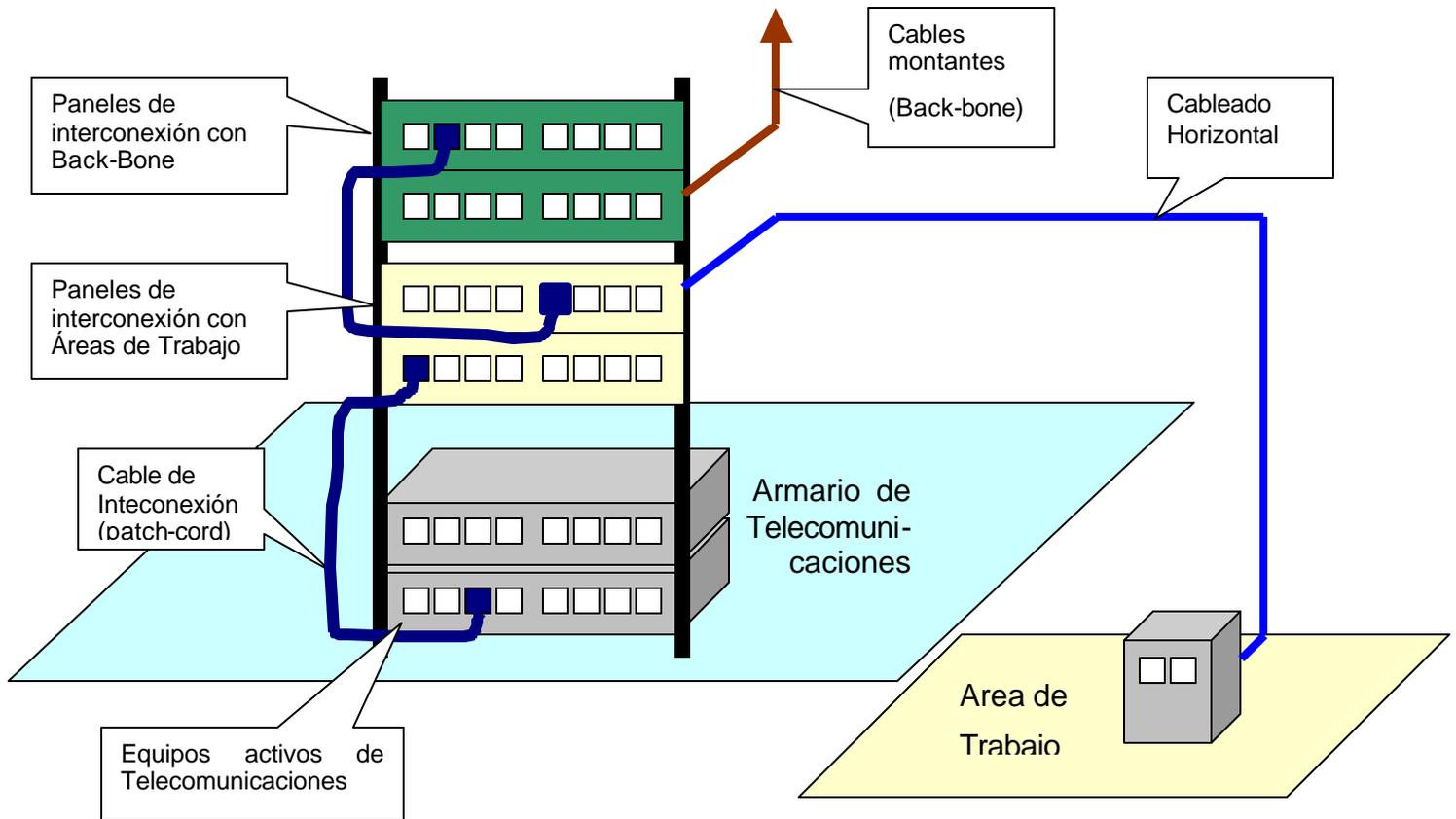
Típicamente los repartidores horizontales, ubicados en los armarios de telecomunicaciones, consisten en “paneles de interconexión”, en los que terminan los cableados horizontales y los cableados de backbone. Estos paneles de interconexión permiten, mediante el uso de “cables de interconexión”, conectar cualquier cable horizontal con cualquier cable de backbone o equipo activo.
