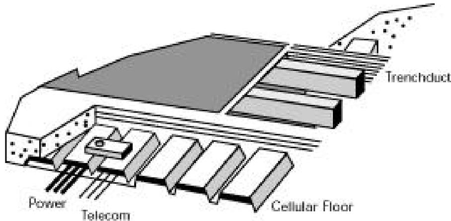
En estos casos los ductos son parte de la obra civil. Bajo el piso se puede realizar una “malla” de ductos, disponiendo de líneas determinadas para telecomunicaciones, energía, etc. En las áreas de trabajo se dispone de puntos de acceso a los ductos bajo piso, utilizando “torretas” u otro tipo de accesorios.
