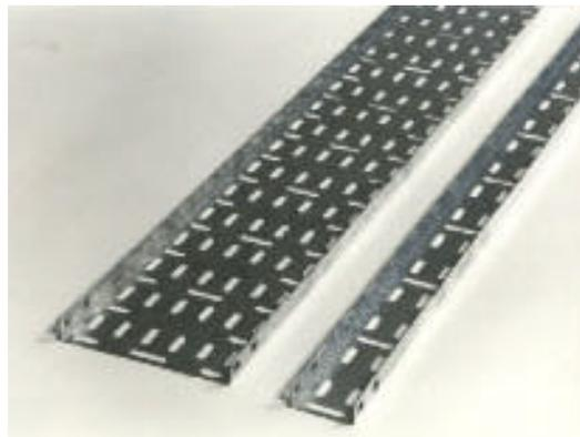
Las bandejas portacables consisten en estructuras rígidas, metálicas o de PVC, generalmente de sección rectangular (en forma de U). La base y la paredes laterales pueden ser sólidas o caladas. Las bandejas de este tipo pueden o no tener tapa.
