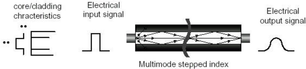
Es de notar que en este tipo de fibras, la luz puede transitar por caminos de distinta longitud total (de acuerdo a cada uno de los “modos”). La velocidad de propagación de la luz dentro del núcleo está dada por
