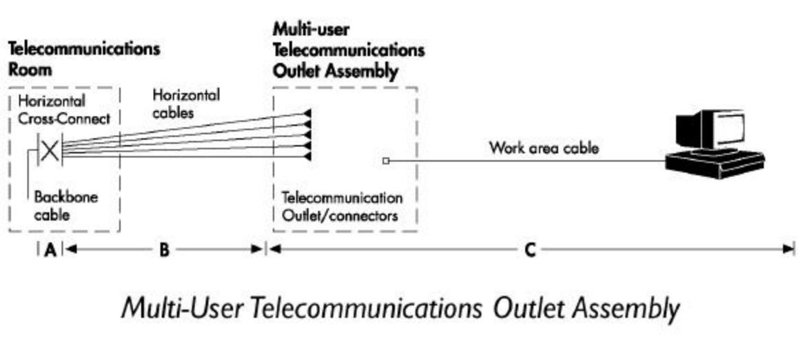
Los “Dispositivos de múltiples conectores de telecomunicaciones” son puntos de terminación del cableado horizontal consistentes en varios conectores en una misma “caja”, típicamente ubicada en puntos cercanos a varias áreas de trabajo. Desde estos puntos, pueden tenderse cordones modulares (del tipo “patch-cords”)
