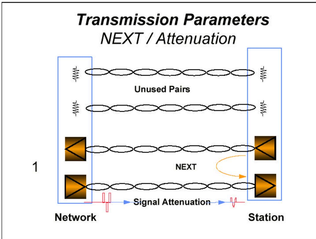
Hay que recordar que los cables admitidos para el cableado horizontal son de 4 pares, los que podrían usarse en forma simultánea y en modo bidireccional (como por ejemplo en aplicaciones Gigabit Ethernet). Esto significa que los 4 pares estarán transmitiendo señales en ambos sentidos a la vez. Es por esto que hay que tener en cuenta la suma de interferencias (en ambos sentidos) sobre un determinado par.
