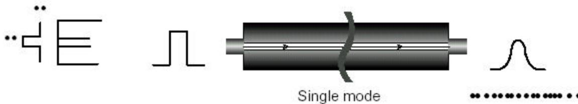
Las fibras monomodo comerciales tienen diámetros de 9/125  $\mu$ m. Las ventanas utilizadas son las de 1300 nm y 1550 nm, con emisores del tipo LASER.
