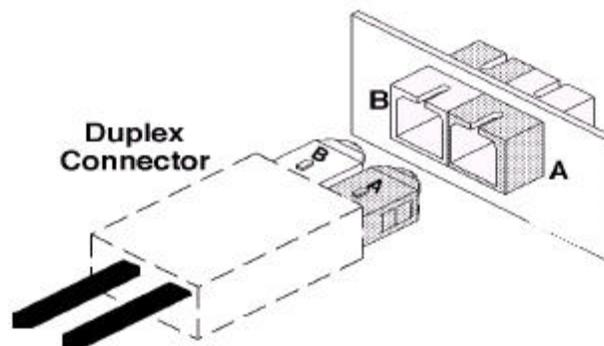
Se recomienda utilizar el conector 568SC, pero se admiten otros tipos de conectores de dimensiones adecuadas. La figura muestra un conector del tipo 568SC y un cordón de interconexión de fibra óptica con su correspondiente terminación 568SC
