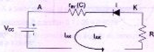
Figura 2.32 Circuito del ejercicio 2.1 suponiendo un diodo ideal
