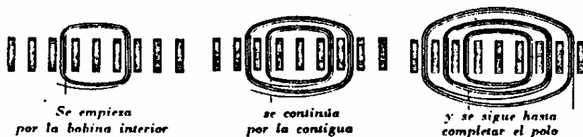
Manera de bobinar a mano un polo de un estator.
