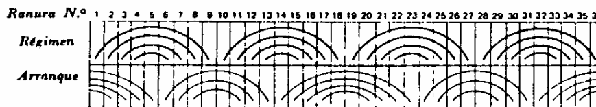
Diagrama de pasos para un motor de 4 polos y 36 ranuras. Los polos del arrollamiento de arranque no tienen siempre el mismo número de bobinas, sino que éste oscila alternativamente de 3 a 4.
