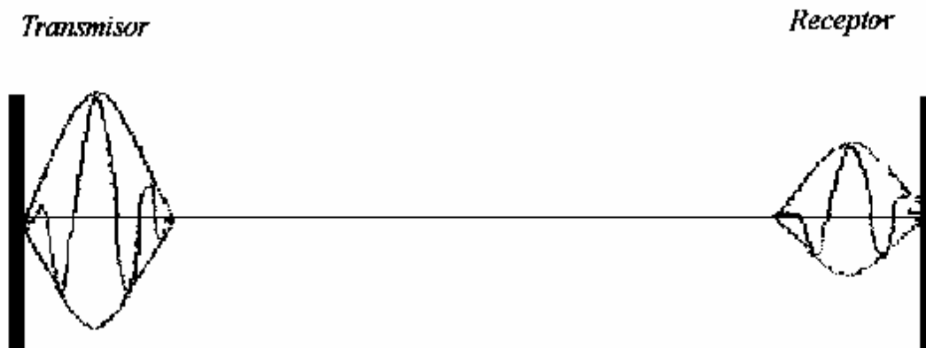
Fig. 6.4 Dispersión de paquetes de onda en medios de transmisión dispersivos
