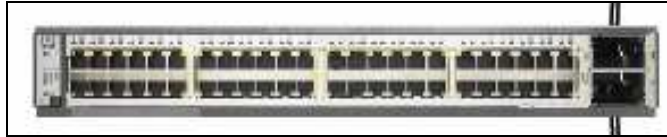
Figura 2.21 Switch de distribución Cisco 3750
