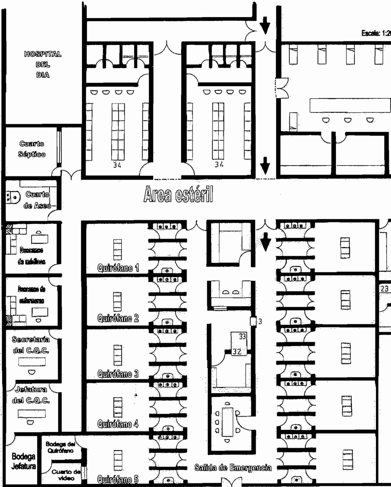
Figura 3.1.1.a. Esquema de la planta física de un C.Q.C. Tipo.
