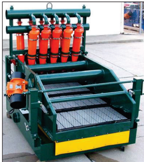
FIGURA 2.27 LIMPIADOR DE LODO
