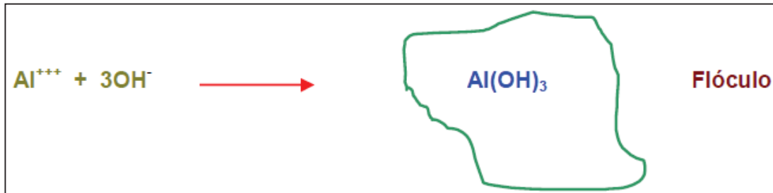
FIGURA 3.6 COAGULACIÓN POR PRECIPITACIÓN Y ATRAPAMIENTO
