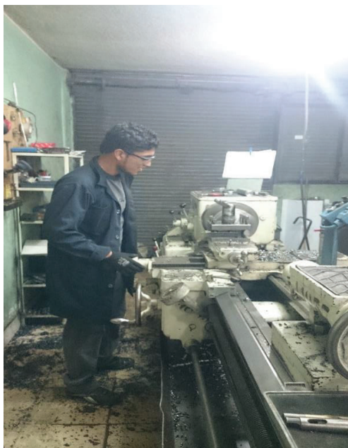
Ilustración 5.1 Construcción del rodillo motriz
