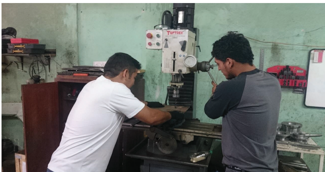
Ilustración 5.2 Construcción de la plancha base
