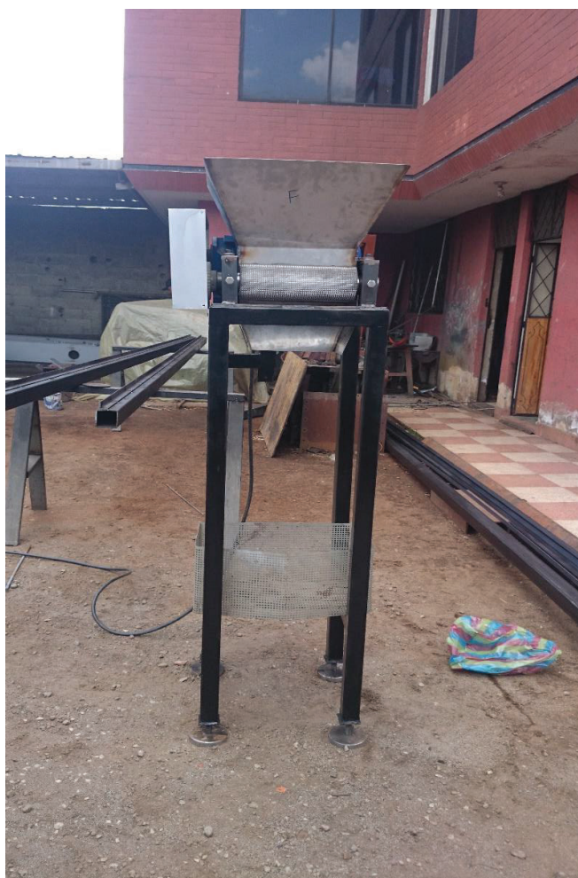
Ilustración 5.6 Máquina trituradora de hojas de guayusa
