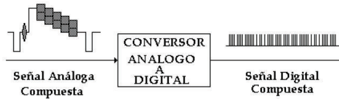
Figura N° 2.5: Codificación de señales compuestas
