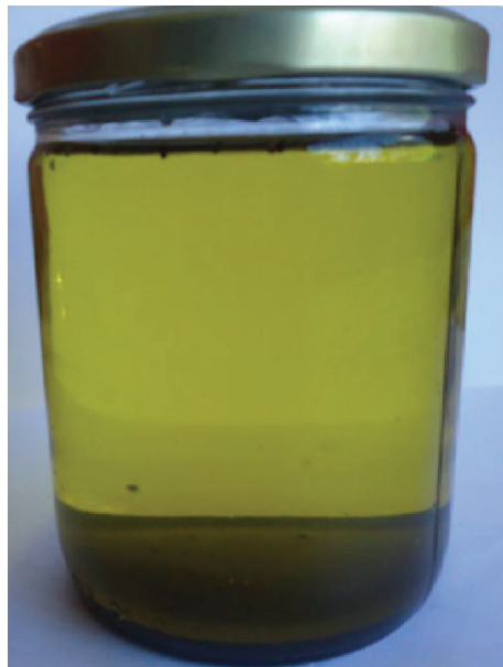
Figura AX.2. Aceite de chía después del proceso de sedimentación
