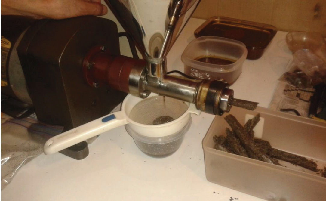
Figura AIII.1. Extracción del aceite de chía.
