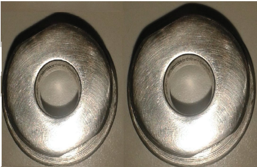
Figura AIII.2. Boquillas de la prensa expeller utilizadas en la extracción
