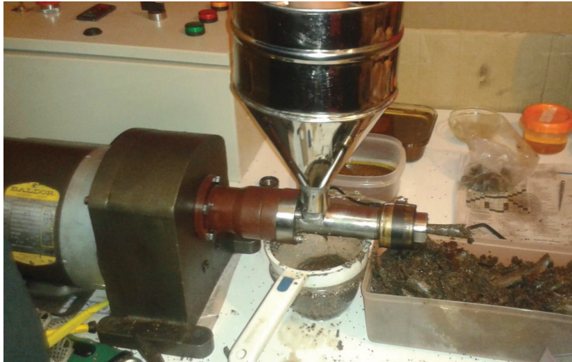
Figura 2.1. Representación y funcionamiento de la prensa expeller
